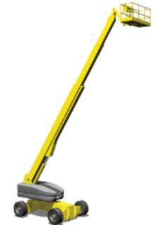
Flèche mobile (3b): Plateformes élévatrices à flèche mobile durant l'utilisation
