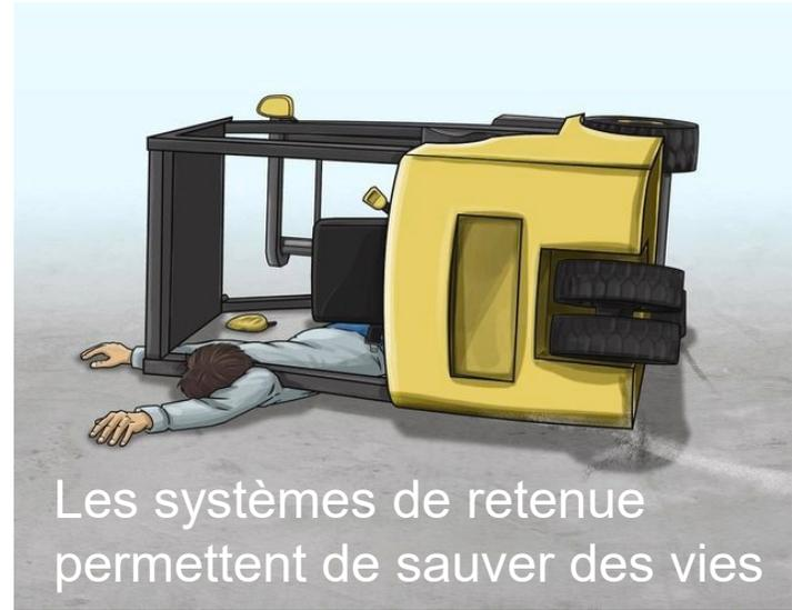
Les systèmes de retenue permettent de sauver des vies
