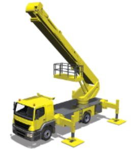
Boom statique (1b): Plateformes élévatrices à flèche sur véhicules
