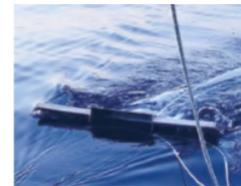
Filet manta utilisé pour les prélèvements de microplastiques dans les eaux de surface. Photo: [www.5gyres.org](http://www.5gyres.org)
