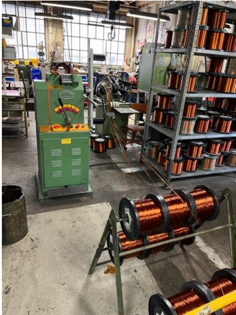
Machine manuelle pour rebobinage
