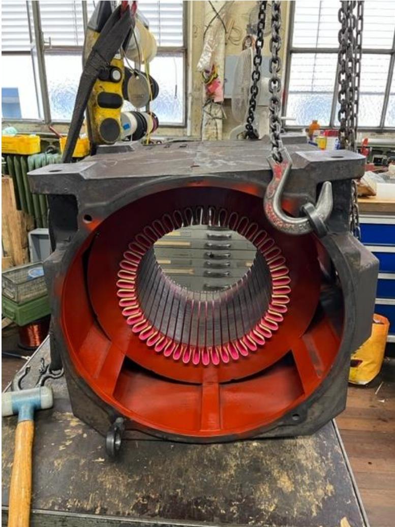
Préparation nouvelles encoches stator
