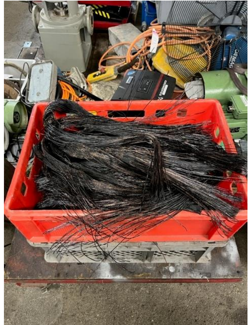
Cuivre brûlé enlevé sur ancien bobinage
