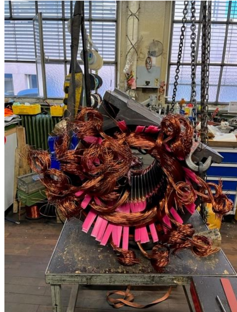
Introduction des nouvelles torches de fil de cuivre dans les encoches stator
