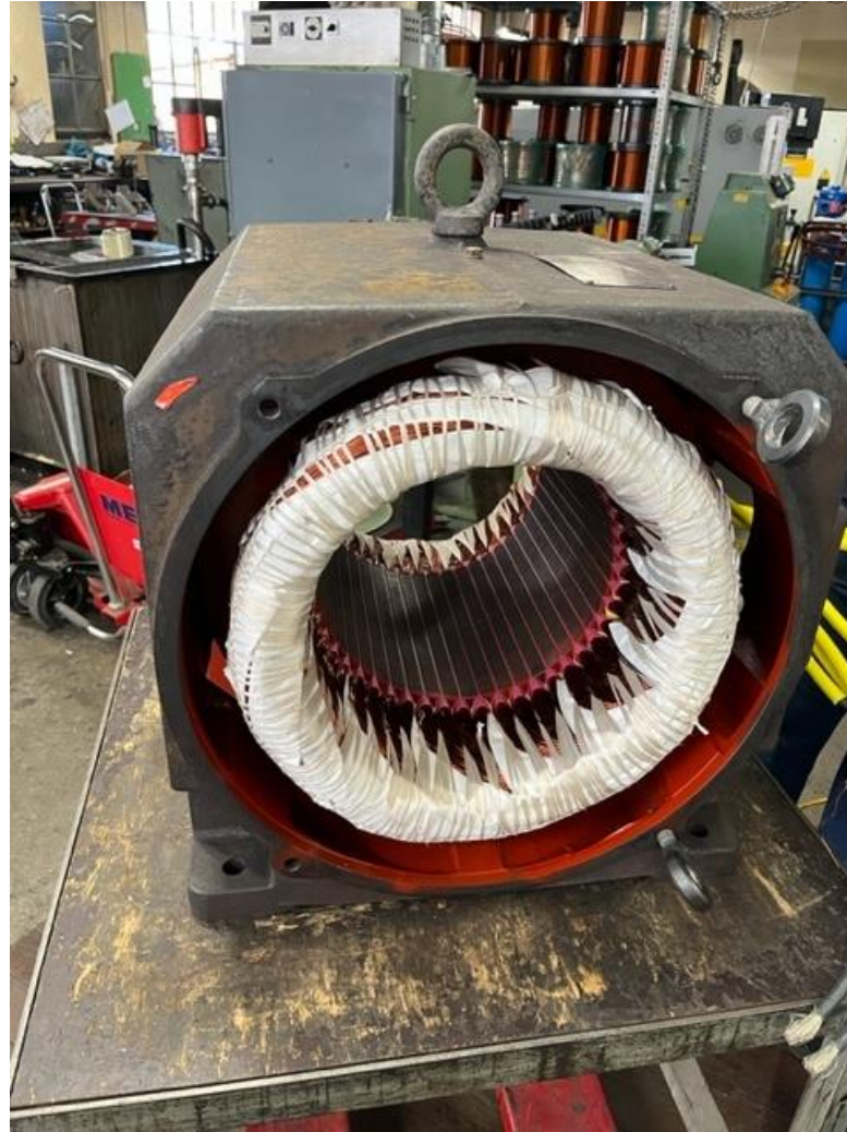
Finition du rebobinage du stator
