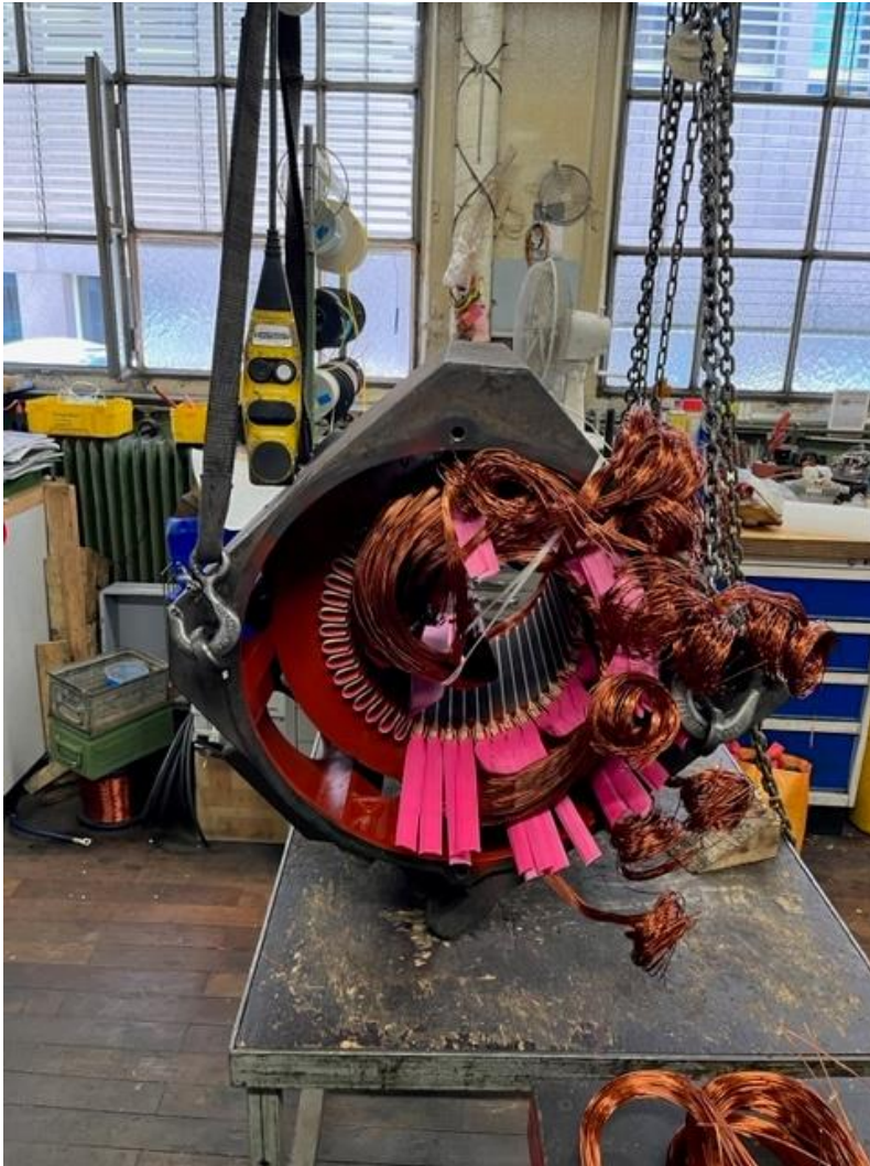
Introduction des nouvelles torches de fil de cuivre dans les encoches stator
